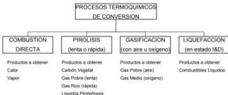
Figura 3. Proceso termodinámico en conversión.
