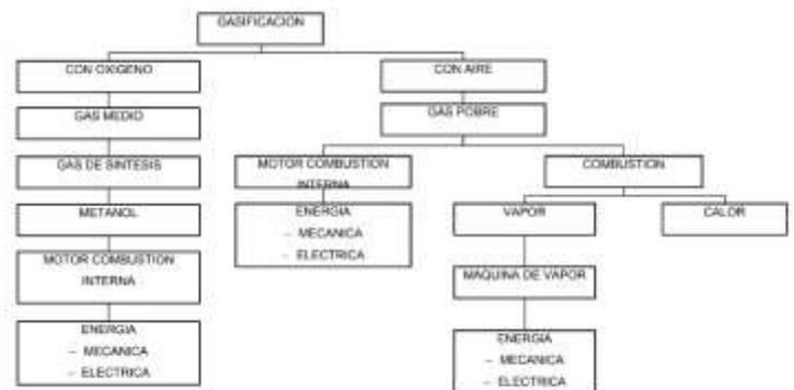
Figura 4. Proceso de Gasificación de biomasa.
