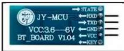
Fig. 4. Interfaz Bluetooth conectada al Arduino Uno.
