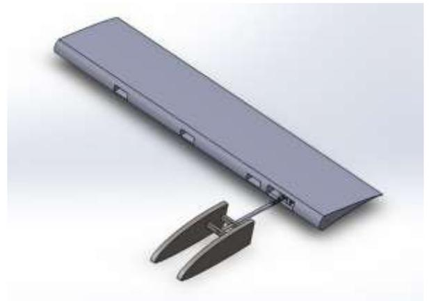
*Fig. 5.- Pala de aerogenerador con mecanismo de tornillo sinfín.*
