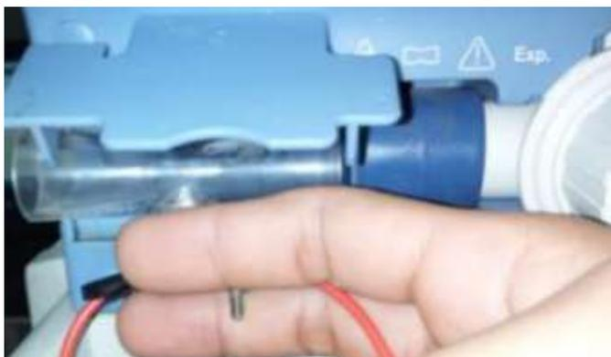
**Fig. 2. Conexión del filamento de tungsteno con el ventilador Dräger**
