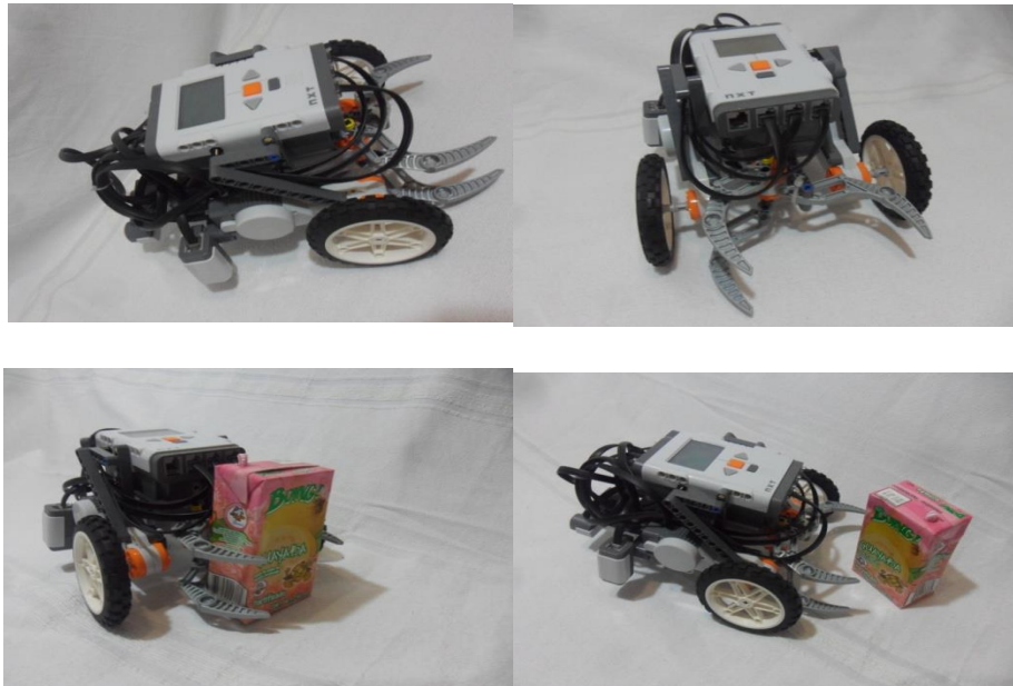
Figura 7. Fotografías de BoingCollector. BoingCollector tiene una estructura física compuesta de bloques y piezas técnicas LEGO® la cual ha sido propuesta de manera original.
