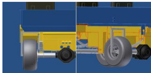
Figura 4 - Modelo CAD 3D de la fijación de la propuesta de odómetro óptico.
