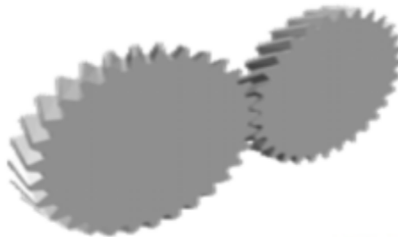
Fig. 6: Sistema de engranajes Helicoidales.
