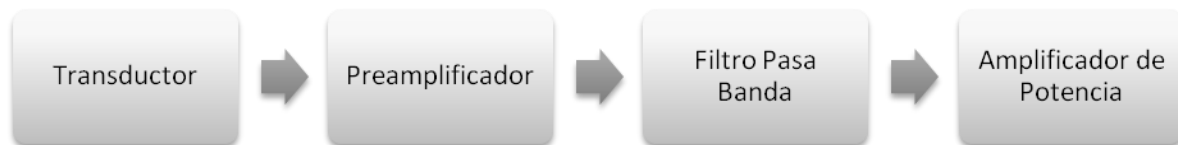
Figura 11. Diagrama a bloques de una Ayuda Auditiva
