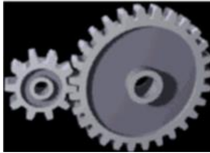
Fig. 7: Conjunto de engranes piñón (engrane menor) y corona (engrane superior).
