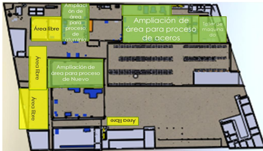
Fig. 4 propuesta 3 ampliación de áreas para procesos de aluminios, aceros y contemplar procesos nuevos.
