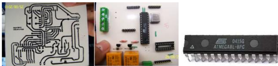
Figura 6. PCB resultado y Microcontrolador utilizado
