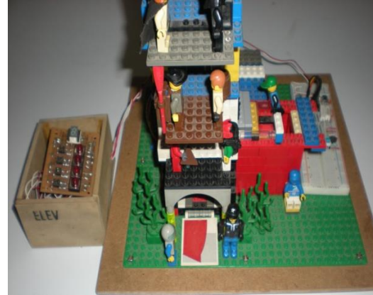
Figura 7. Estructura mecánica LEGO®. Funcionamiento del prototipo elevador de 4 pisos.
