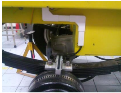
Figura 8 - Prototipo final del odómetro. Este prototipo es la salida de la metodología seguida.
