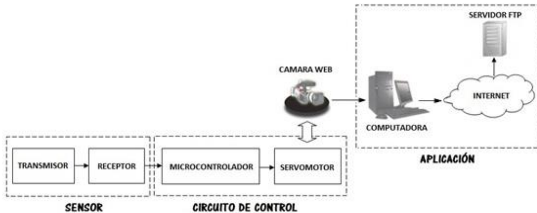
Figura 2-1 Diagrama de bloques de un sistema de monitoreo visual remoto con movimiento autónomo
