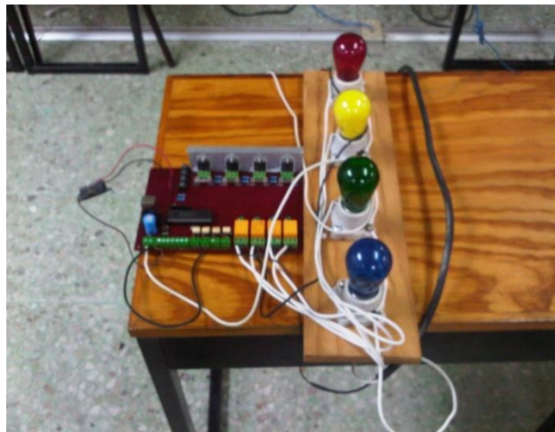
Fig.4. Comprobación del PLC en la etapa de potencia (relevadores)
