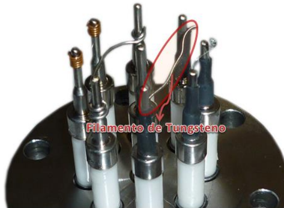
Fig 2.1 localizacion del filamento de tungsteno en el atravezador
