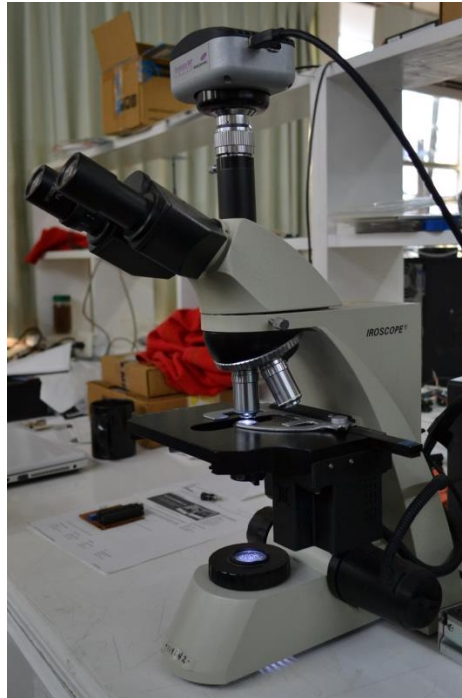
Figura 4. Microscopio óptico con la cámara y los motores que se utilizaron en el sistema.
