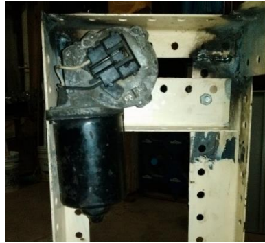
Figura 4. Motor montado en la estructura metálica (Gabinete).
