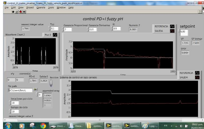
Figura 16. Front panel del control PD+i difuso.
