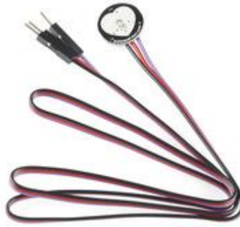
Fig. 7 Sensor analógico empleado para captar la señal del corazón.
