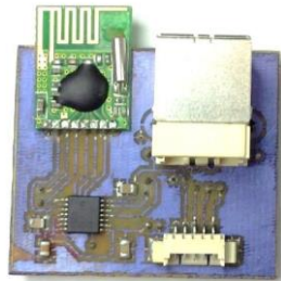
Figura 28. Módulo de recepción de datos
