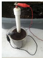
Fig. 7.- Medición del voltaje natural de corrosión de una pieza de acero
