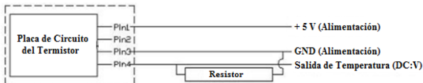
Fig. 5.- Conexión del Sensor de Temperatura.
