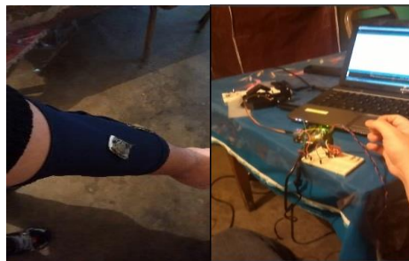
Fig. 10. Mangas con electrodos de tela de plata y Manipulación del gripper.
