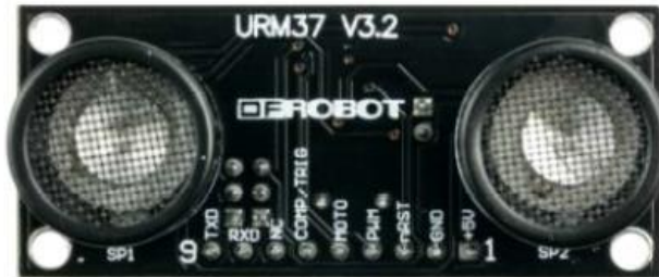
Figura 3. Distribución de terminales del sensor URM37 V3.2.
