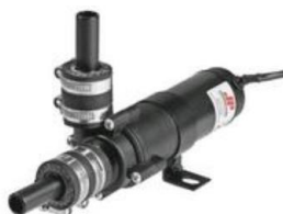
Figura 2. Bomba Centrífuga para hacer circular y bombear agua, se alimenta con 24 Vcd y proporciona un caudal aproximado de 5 l/min.
