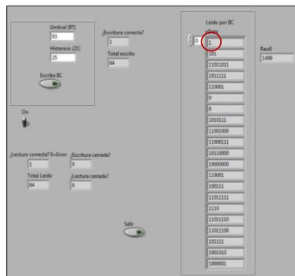
Fig. 11 Interfaz de LabView que muestra en el primer bit leído por comunicación I 2 C un uno que indica que el sensor se está tocando.
