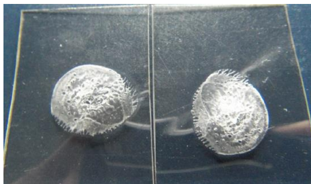
Figura 1.- Prueba de compatibilidad de adherencia con fallo cohesivo.
