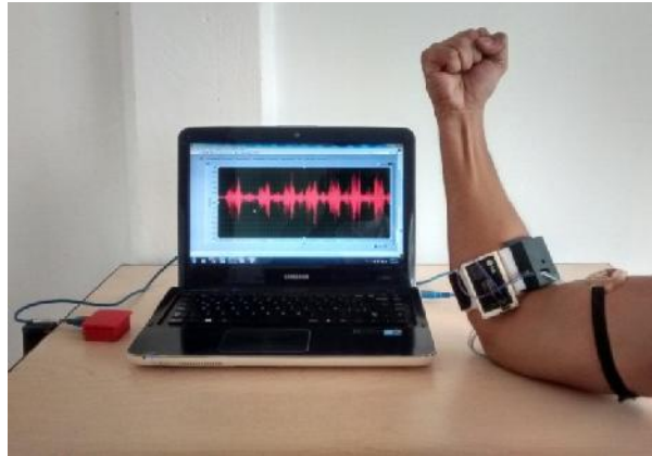
Figura 2. Sistema de registro de actividad de sEMG y de movimiento.
