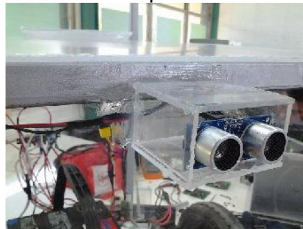
Figura 10: Sensores ultrasónicos instalados
