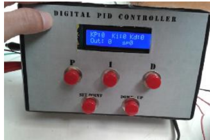
Figura 6. Instrumento Controlador digital en prueba final de operación
