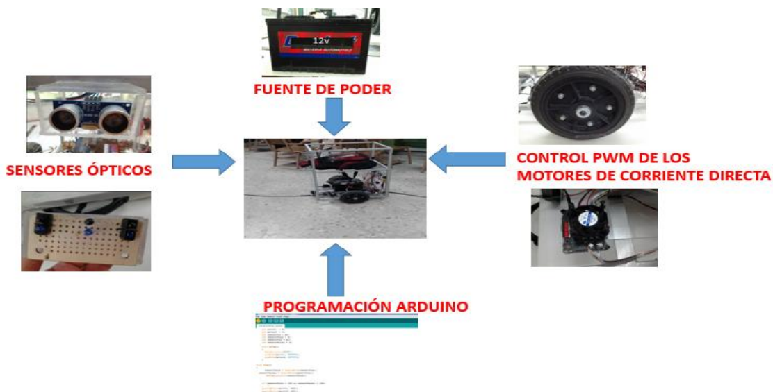
Figura 2: Diagrama general del prototipo diseñado
