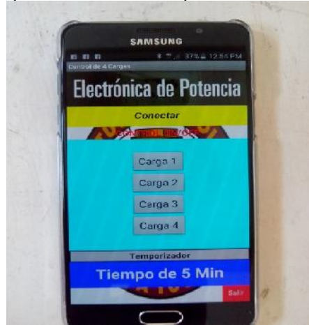
Figura 10. Aplicación del programa para cuatro cargas en un dispositivo móvil
