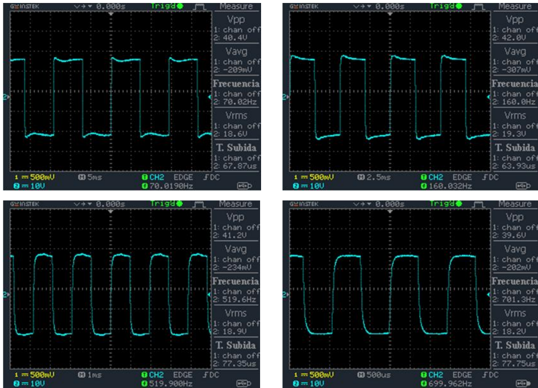
Fig.10. Salida del inversor a diferentes frecuencias.
