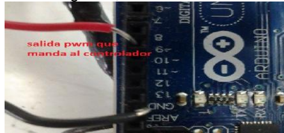
Figura 7: Conexión de las salidas del arduino que son mandadas al controlador Víctor 884.
