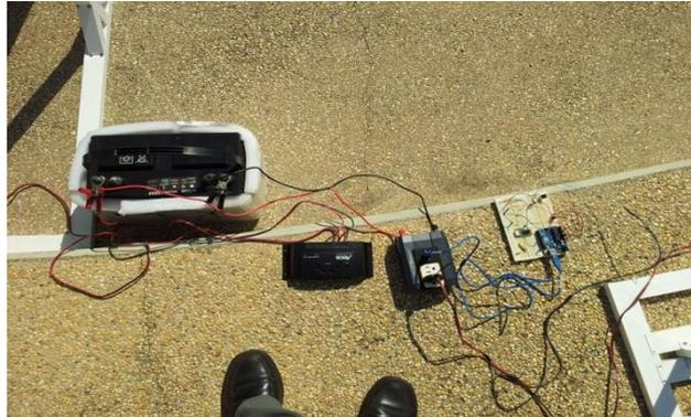
Fig. 14. Sistema de control de carga, Arduino, inversor y batería.
