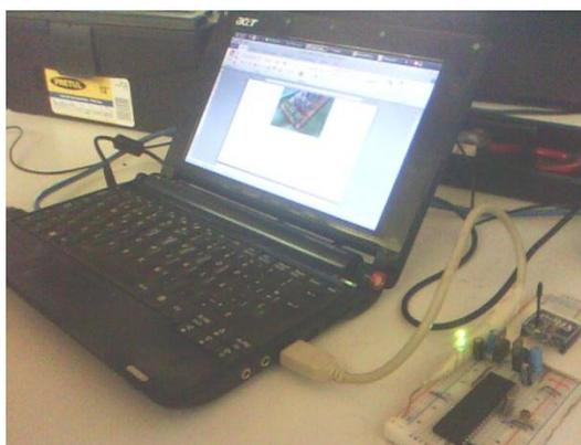
Figura 10.-Comunicación del Módulo XBee con la PC.
