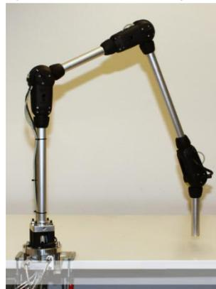
Fig. 2. Brazo robótico flexible.
