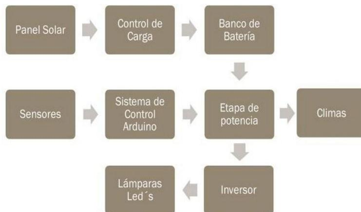
Fig. 1. Diagrama general de la automatización del Centro Acuícola del ITESCO.
