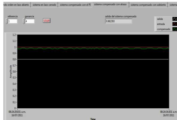
Figura 18.- Respuesta estable compensador atraso.
