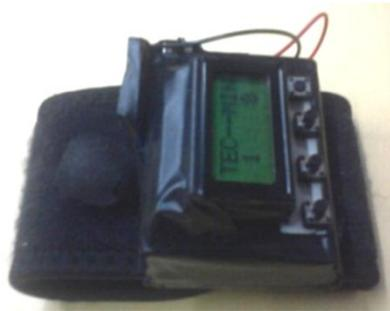
Figura 1. Muñequera háptica con retroalimentación vibrotáctil aplicada en la Transferencia de Habilidades.
