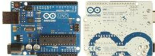
Figura 1. Tarjeta con plataforma arduino
