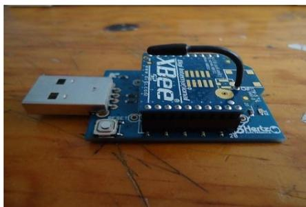
Figura 9.- Dispositivo de comunicación entre la Computadora
