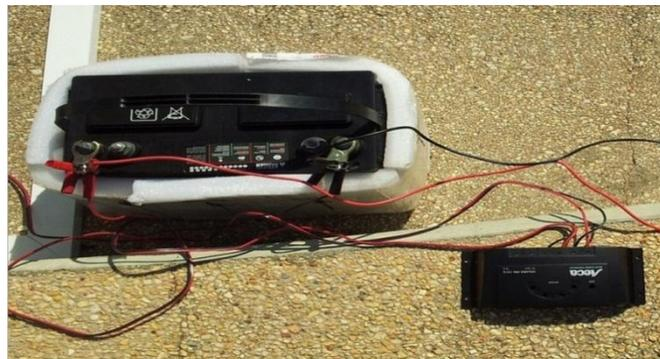
Fig. 3. Controlador de carga Steca PRS1515 de 15 A
