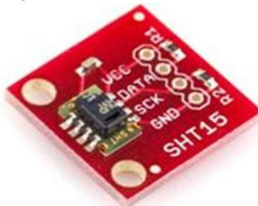
**Figura 3 Sensor de humedad y temperatura**
