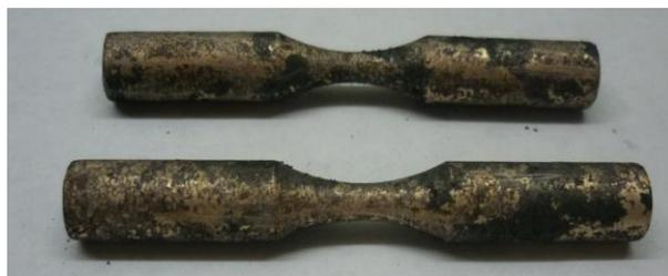
Figura 2. Probeta para ensayos de fatiga después del tratamiento de boronizado.
