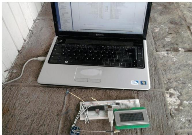
Figura 11.- Computadora transmitiendo datos del XBee
