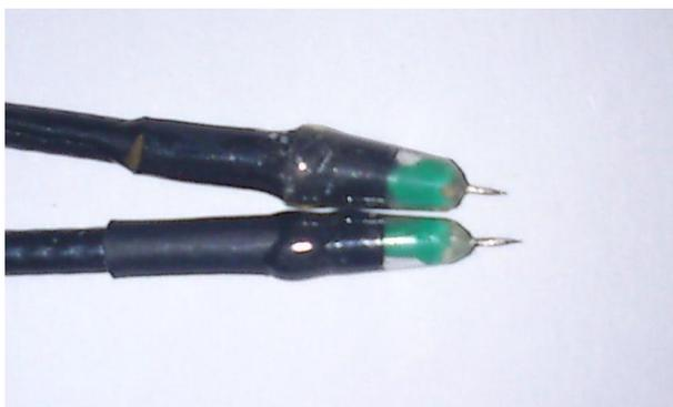
**Fig. 7 Microelectrodos de platino**
