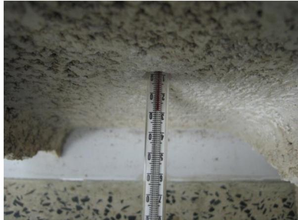
Fotografía 2. Colocación del termómetro
