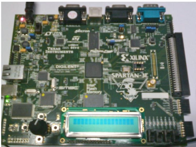
Figura 1. Tarjeta de desarrollo basado en un FPGA Spartan
