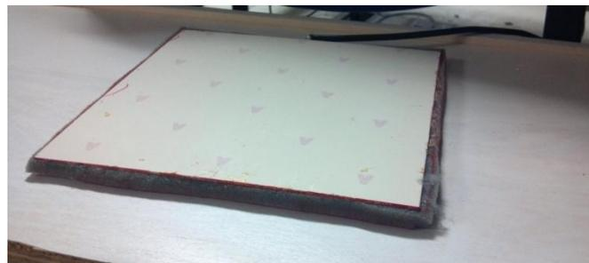
Figura 3.- Sensor capacitivo implementado para detectar la presencia de personas sentadas.
