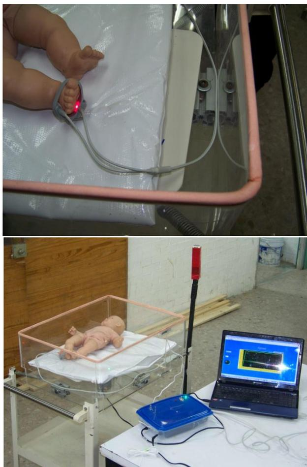
Figura 2. A) Sensores de oxígeno SpO2 y sensor de movimiento. B) Cunero con sistema de monitoreo.
