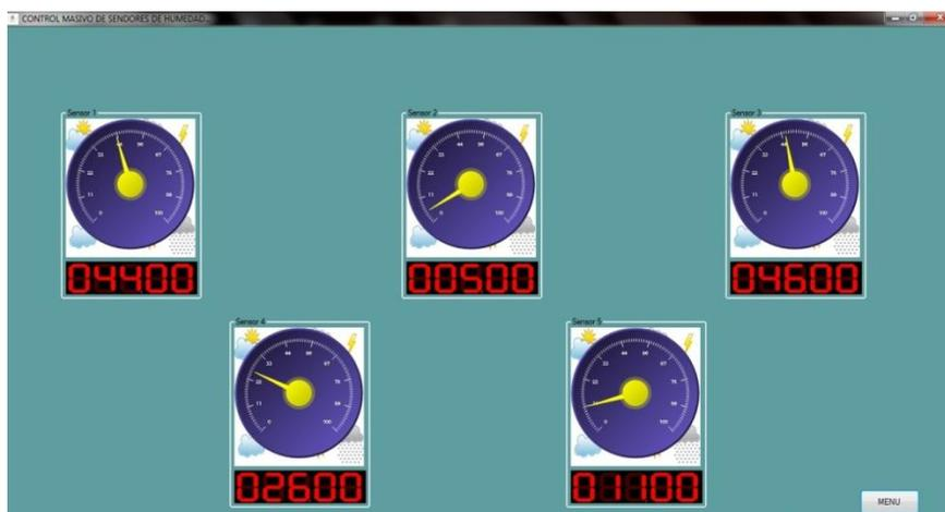
Figura 7. Interfaz de los objetos gráficos para los sensores de humedad.
