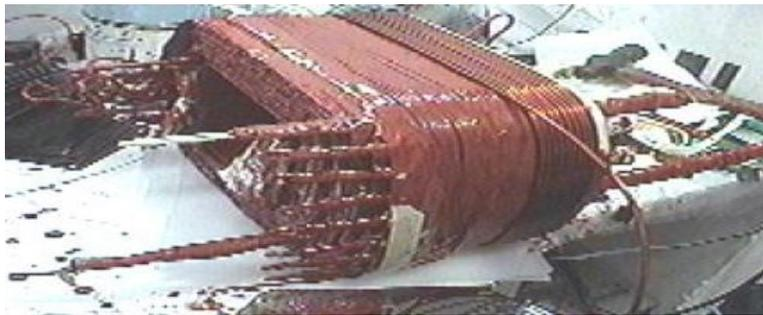
Figura No. 12. Fotografía que muestra el proceso de embobinado con alambre magneto del transformador principal (T1), fuente propia.
