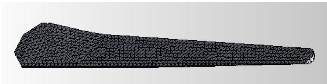
En la Figura 6 se muestra la representación del asa por medio de un mallado de la pieza, cada cruce es un nodo; siendo cada uno un punto de análisis del modelo. El programa realizó el análisis del elemento en 12842 cruces.
