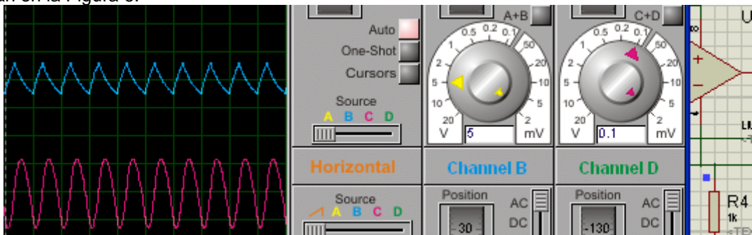
Figura 6.- Señales obtenidas en cada integrador onda triangular y sinusoidal respectivamente.
