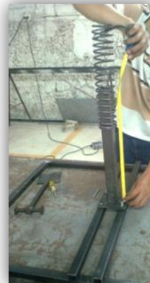
Figura 12: Calibración de Longitud sólida del resorte.
