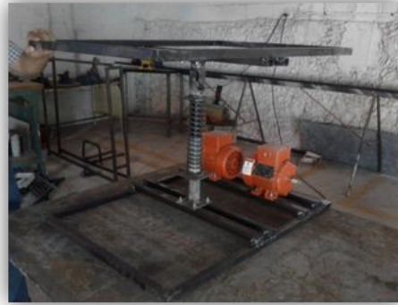
Figura 16: Ensamble de marco estructural para plataforma
