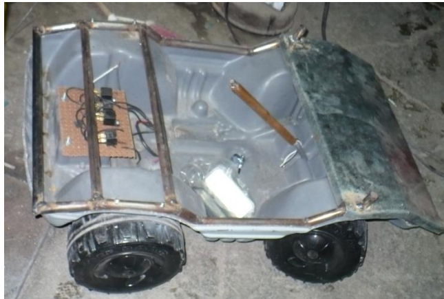
Fotografía I. Base de la estructura de metal y Sistema de control.
