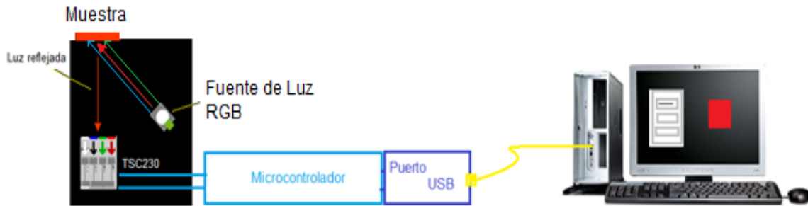
Figura 3. Diagrama a bloques del colorímetro.
