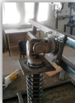
Figura 14: Instalación de cruceta en yugo.
