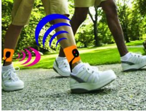
Figura 3. Envío de la información por vía radiofrecuencia al módulo central.
