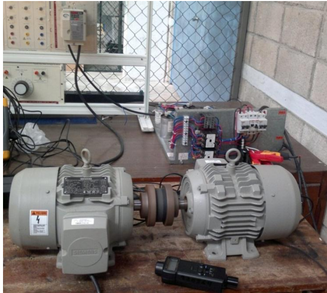
Fig. 5 Sistema del Generador de inducción auto-excitado
