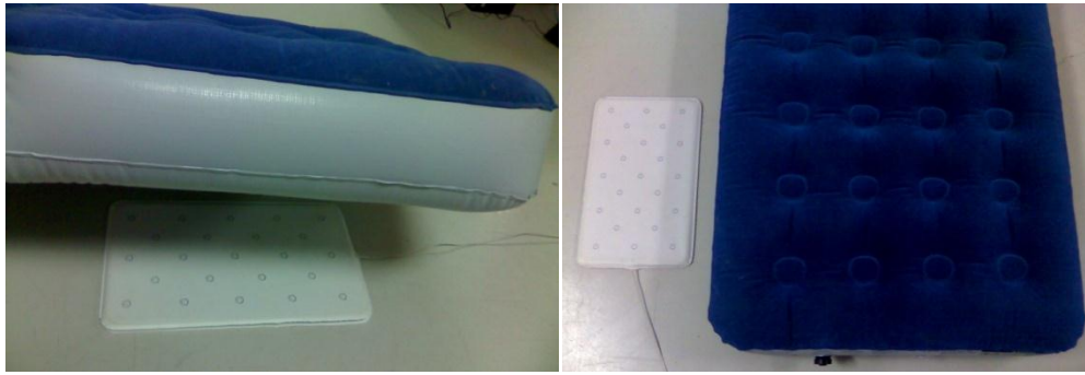
Figura 4. Vista de posición lateral y superior del sensor ubicado bajo el colchón.
