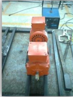
Figura 15: Motores eléctricos instalados en simulador.
