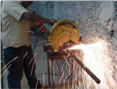
Figura 7: Corte con disco de barra de PTR.
