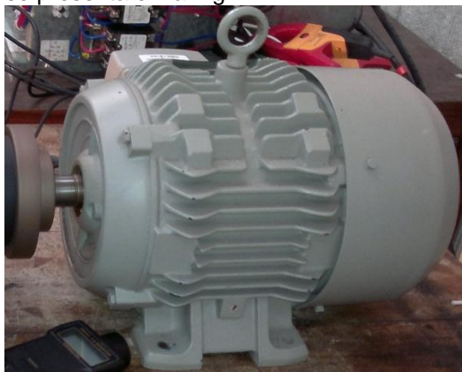
Fig. 1 Motor de inducción empleado como primo motor
