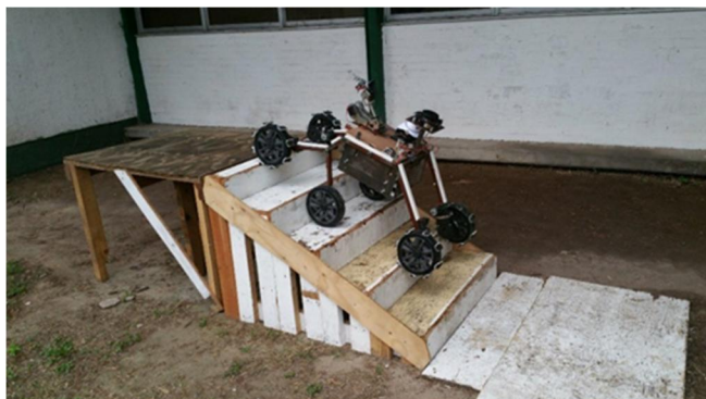
Figura 11: Pruebas realizadas en escaleras.
