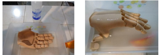
Figura 11. Inmersión de la prótesis en alcohol. (Durante la prueba del alcohol no se observó cambio alguno).
