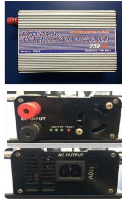
Fig. 2 Inversor Smart Grid 250GT
