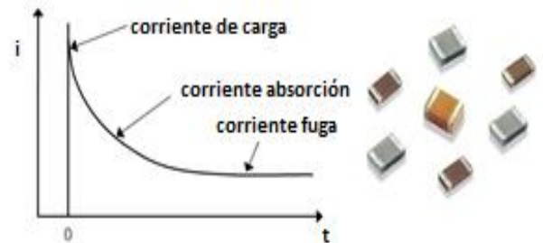
Figura 3 – Perfiles de corriente en un capacitor.
