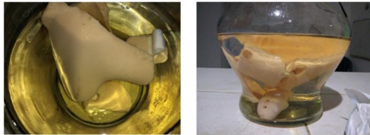
Figura 13. Inmersión de la prótesis en gasolina. (Durante la prueba de la gasolina no se presentó cambio u afección alguna).
