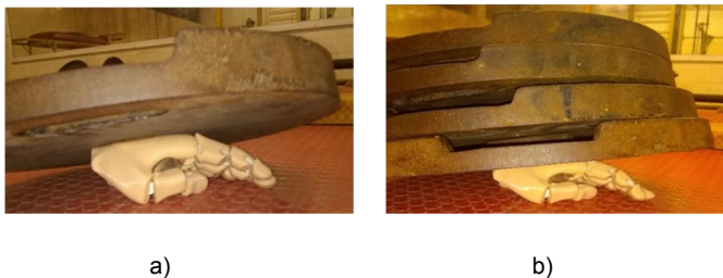
Figura 14. Prueba de presión. (La prótesis soporto 90 kg, con el peso de 100 kg la prótesis se rompió): a) Prótesis sometida a presión de 10 kg y b) Prótesis sometida a presión de 90 kg.
