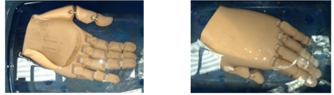
Figura 10. Inmersión de la prótesis en agua. (Durante la prueba no se apreció cambio alguno en la prótesis).
