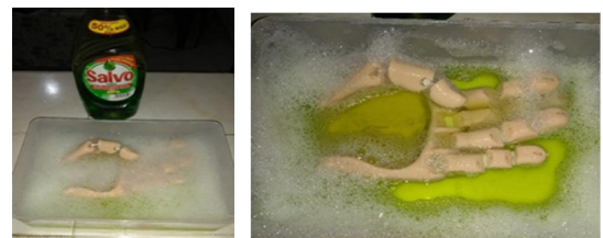
Figura 12. Inmersión de la prótesis en detergente. (Durante la prueba del detergente no se presentó cambio alguno).
