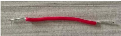
**Fig. 16 Cable sin 1 cm de recubrimiento**
