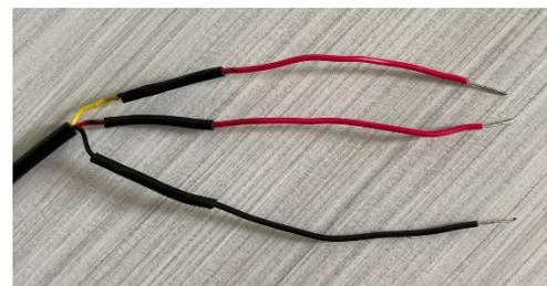
**Fig. 18 Thermofit sobre los cables**
